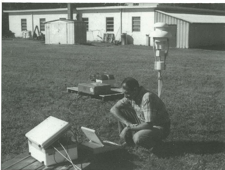
En cours d'essai, contrôle de la puissance émise par la balise. Measuring radiated power.
